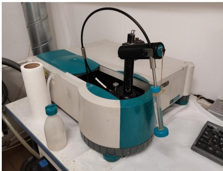
Slika 3: UV-VIS spektrofotometer (lasten vir)
