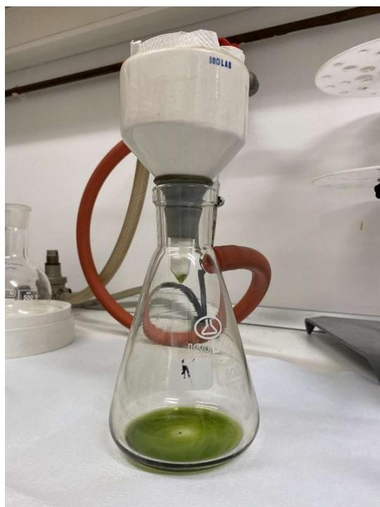
Slika 9: Filtracija s podtlakom (lasten vir)
