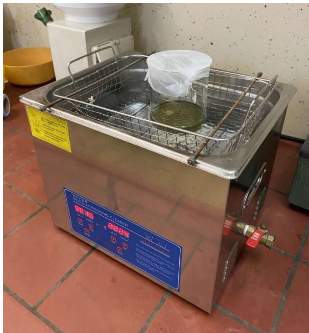
Slika 7: Ultrazvočna kopel (lasten vir)
