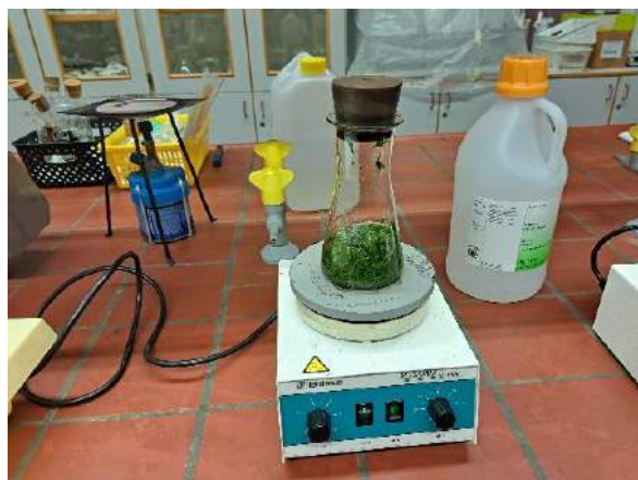
Slika 17: Mešanje vzorcev z magnetnim mešalom (vir: Julija Kronvogel)
