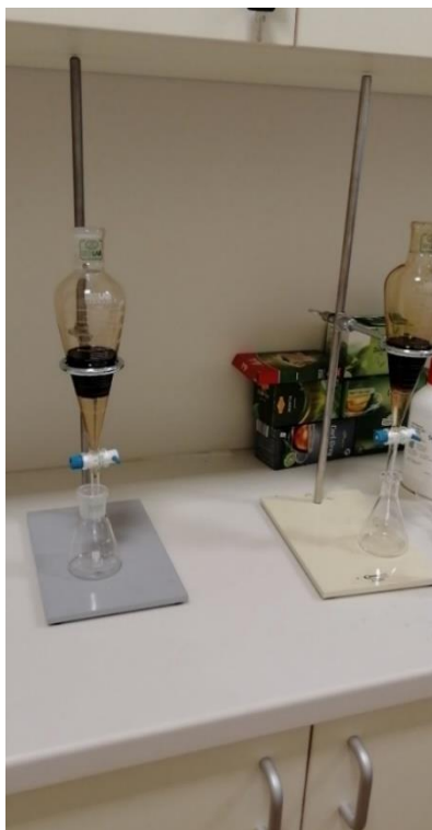
Slika 8: Ekstrakcija z diklorometanom – ločevanje plasti
