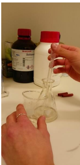
Slika 11: Odpipetiranje topila s kofeinom
