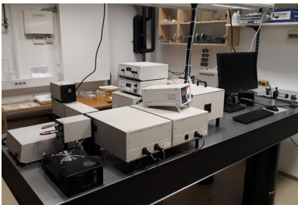
Slika 18: Optični spektrofluorometer Horiba-PTI QuantaMaster 8000 (IJS, 2023)
