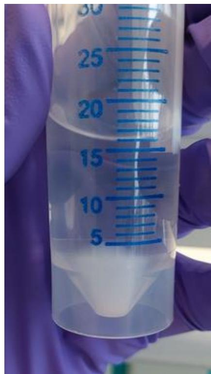
Slika 16: Usedlina  $\text{NaYF}_4@\text{AL}$  po 4. spiranju
