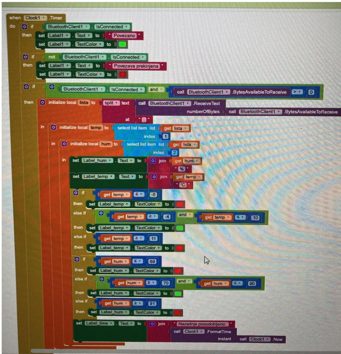
Slika 28: Programirljivi bloki za izpis temperature in vlage na zaslonu
