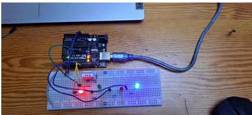
*Slika 33: Testno vezje za DHT22 senzor*
