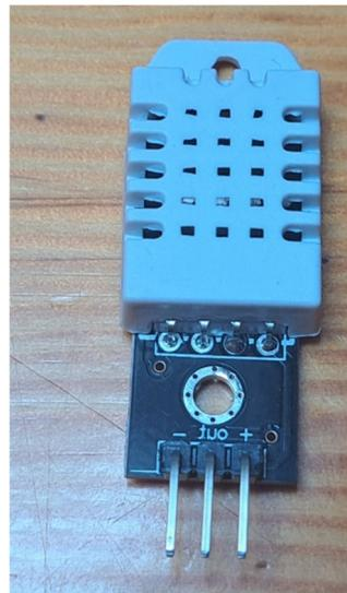
*Slika 12: DHT22 senzor*
