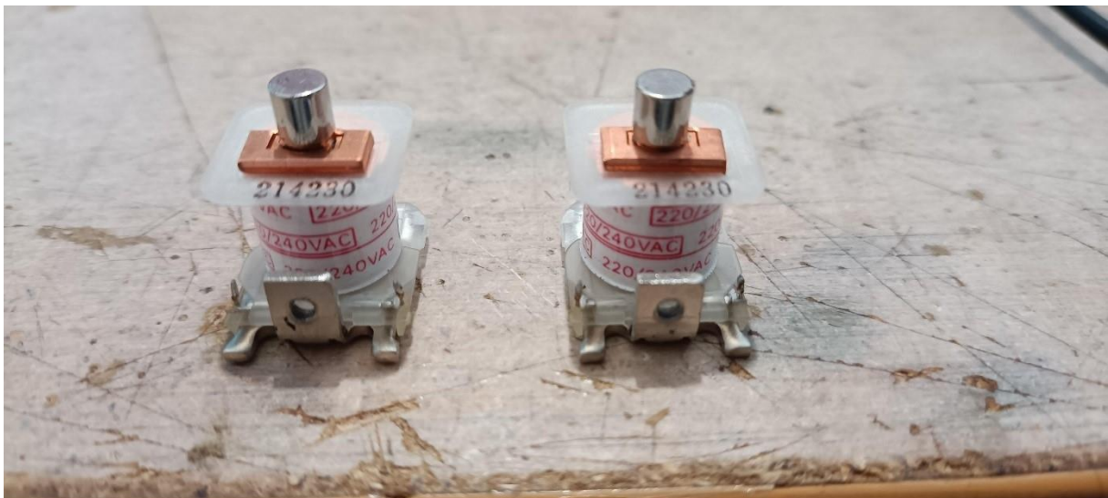
Slika 24: Že naviti tuljavi iz relejev
