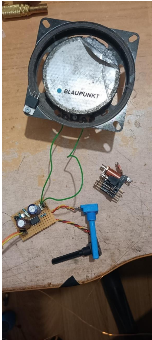
Slika: Potenciometer z ojačevalcem zvoka priklopljen na zvočnik
