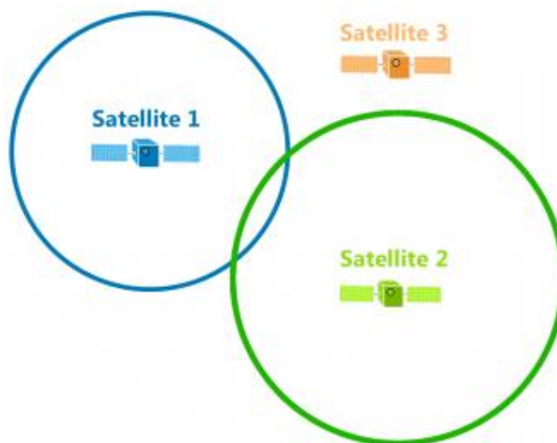
Slika 8: Princip trilateracije - pridobivanje signala drugega satelita. 8
