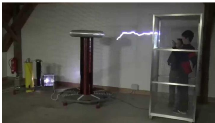
Slika 1: Faradejeva kletka, ki ščiti pred visoko napetostjo.
