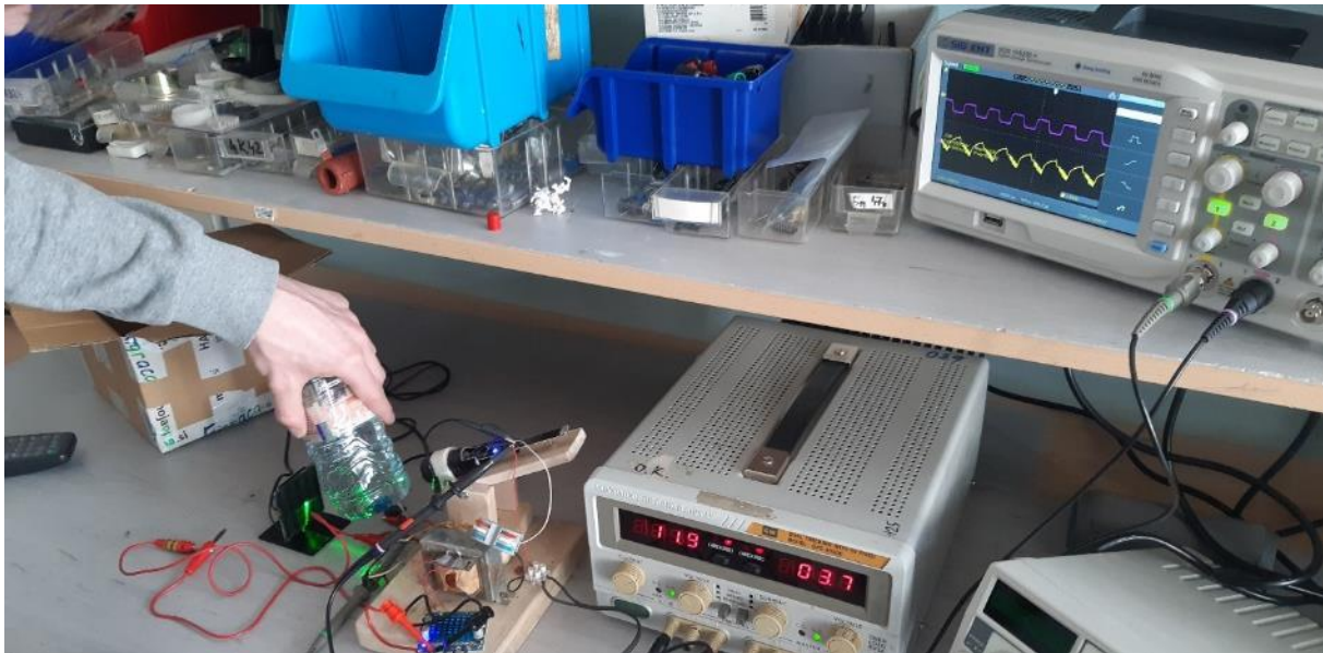
Slika 10: Laser z »vodnim difuzorjem«.
