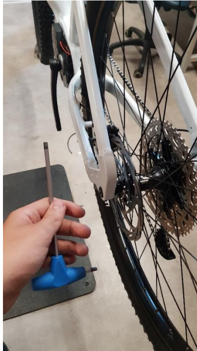
Slika 5: Montaža zavornega sklopa
