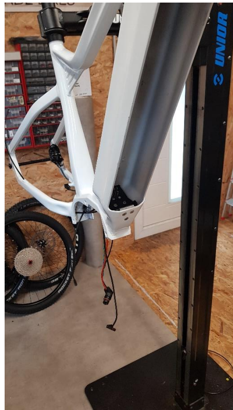
Slika 8: Priprava konektorja za baterijo
