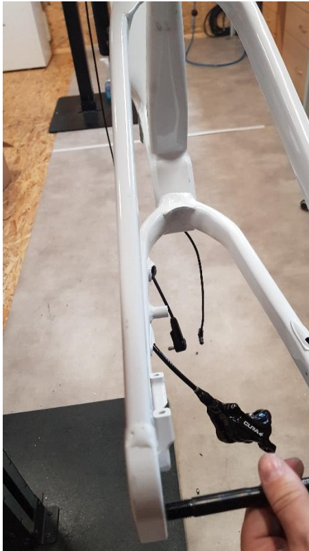
Slika 7: Montaža električnega senzorja motorja
