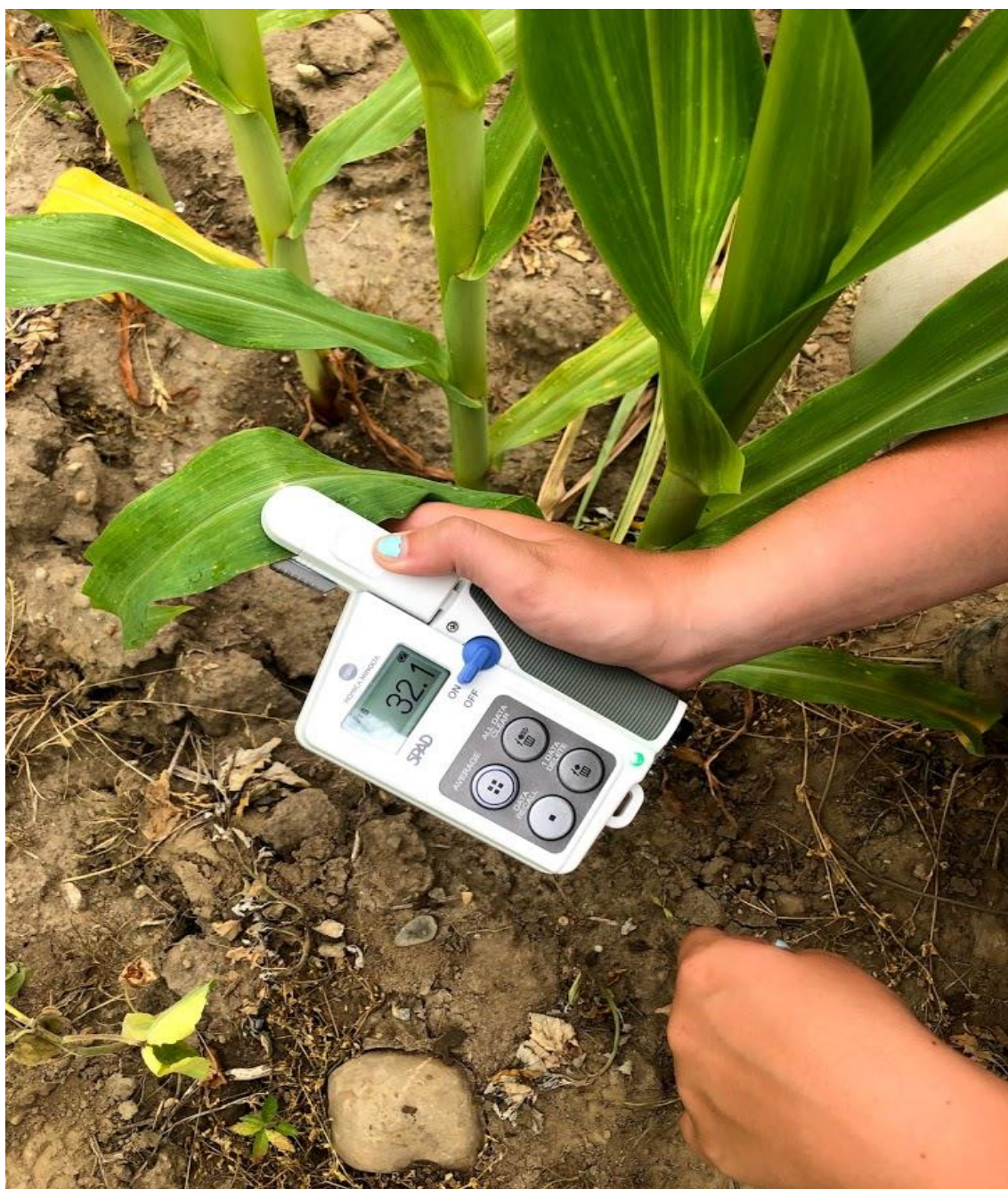
Slika 6: Uporaba klorofilmetra za določanje intenzitete tvorbe klorofila v koruzi (Vir: Titan, 2022)
