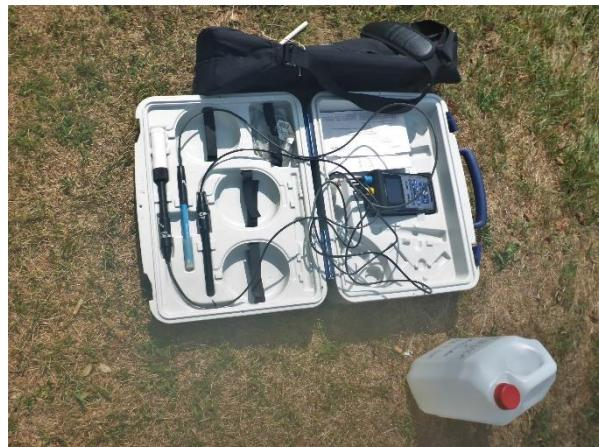
Slika 3: Sonde za merjenje prevodnosti, kisika, temperature in pH (Vir: Arhiv NIB)
