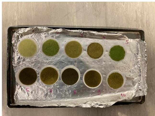
Slika 7: Filtri vzorcev za analizo v laboratoriju (Vir: Arhiv NIB)
