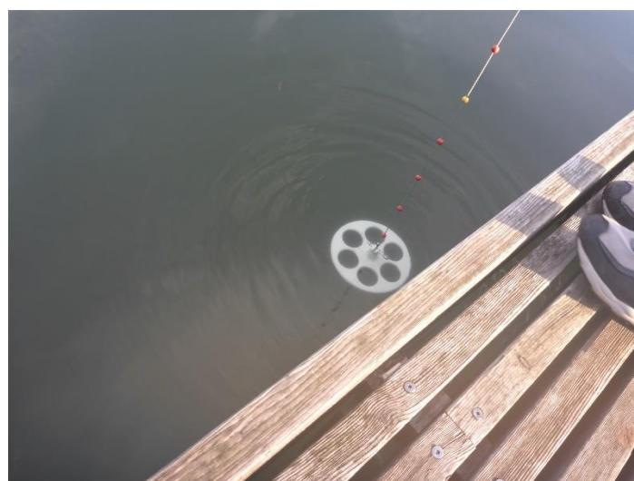
Slika 4: Merjenje Secchijeve globine z diskom (Vir: Arhiv NIB)
