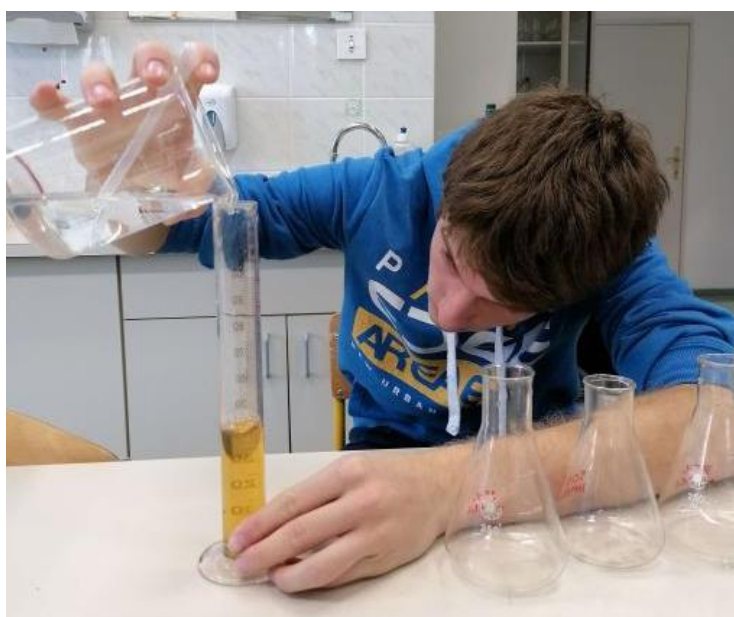
Slika 2: Redčenje 100 % raztopine za pripravo nižjih koncentracij (Foto: Grušovnik V.)
