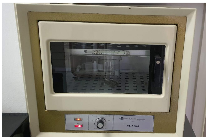
Slika 5: Uničevanje semen pelinolistne žvrklje v sterilizatorju (Foto: Štimac I.)
