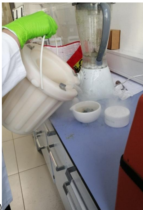
Slika 2: (a) dodajanje tekočega dušika v vzorec, (b) drobljenje vzorca v mešalniku
