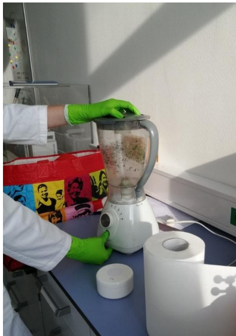
Slika 2: (a) dodajanje tekočega dušika v vzorec, (b) drobljenje vzorca v mešalniku
