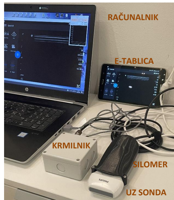
Slika 25: Nadgrajena ultrazvočna sonda s silomerom
