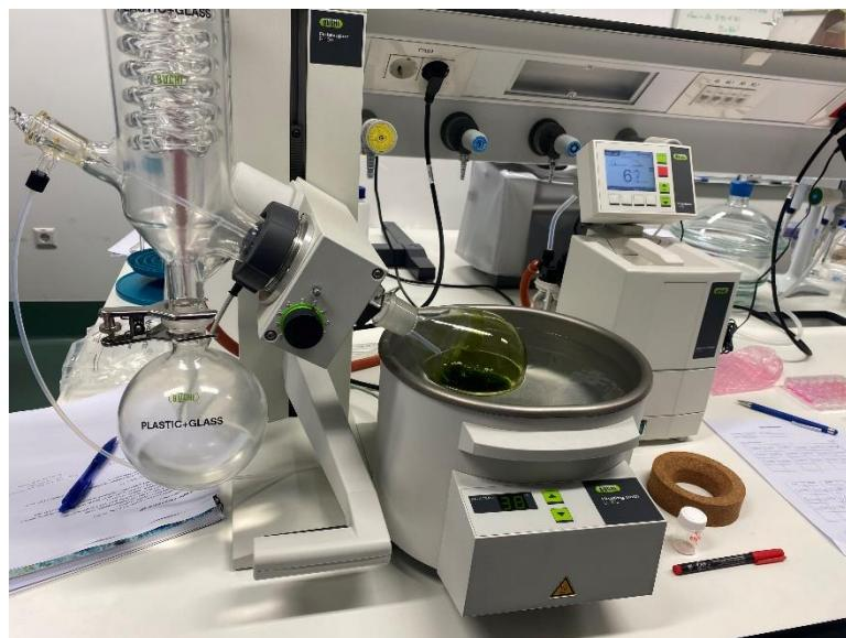
Slika 5: Vakuumski rotacijski izparjevalnik (lastni vir).
