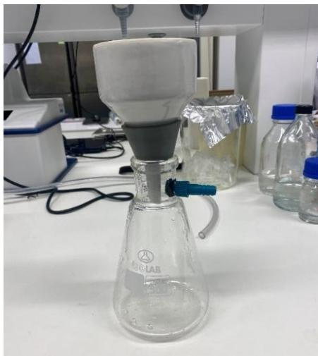
Slika 4: Priprava za vakuumsko filtriranje (lastni vir).
