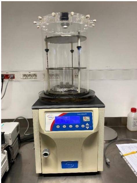
Slika 6: Liofilizator (lastni vir).
