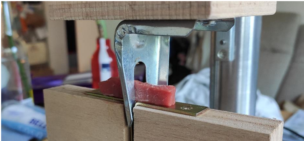
Slika 1: približek doma narejene rezilne naprave (Avtor fotografije: Alja Šlenc, 2022)
