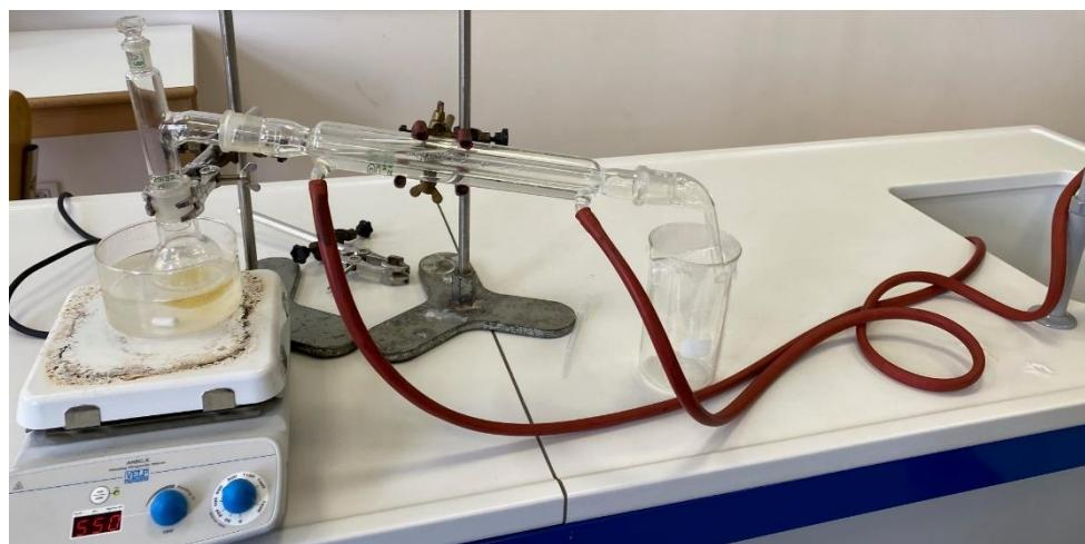
*Slika 3: Aparatura za destilacijo (hladilna cev, destilirna bučka, bučka, gorilnik, izparilnica, 2 stojali, hladna voda iz pipe in čaša) (Brina Lukančič, 2022)*
