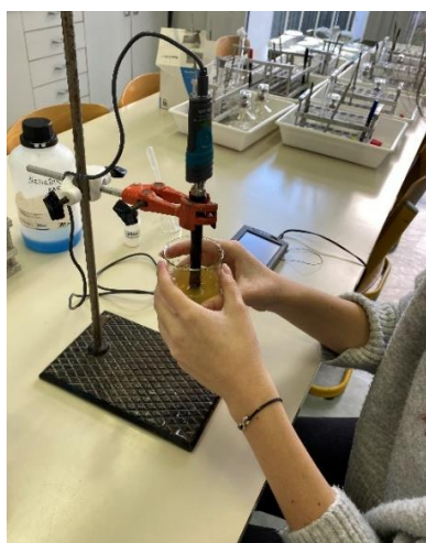
Slika 9: Sonda pH-merilnika v čaši s sladko pijačo (foto: I. Štimac)
