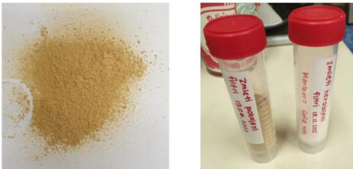
**Slika 14:** Mikroplastika iz pokajenih filtrov navadnih cigaret (levo) in vzorci nerabljene in rabljene mikroplastike (desno) iz filtrov navadnih cigaret (Avtor: Tristan V. Baš).
