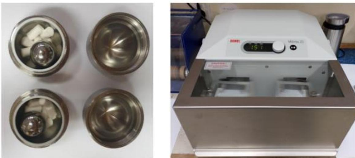
**Slika 13:** Jeklene komore s kroglico (levo) in mlin MillMix 20 (desno) za mletje plastike (Avtor: Tristan V. Baš).
