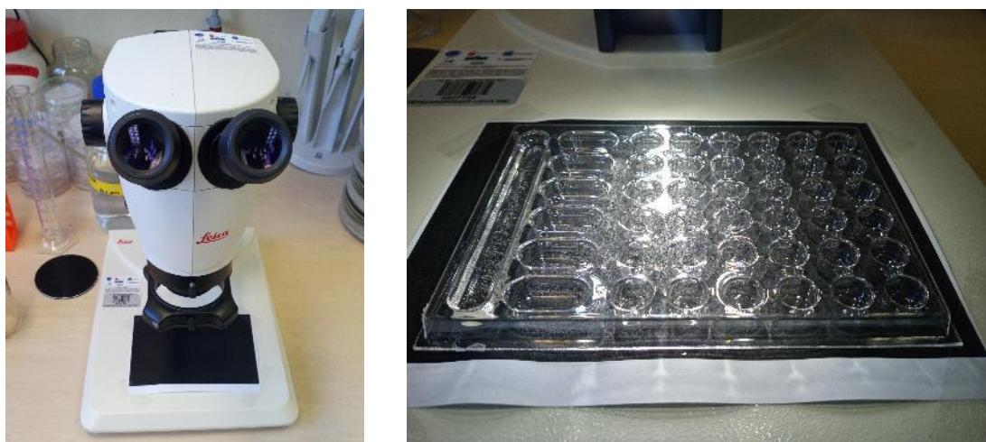
**Slika 33:** Stereolupe Leica za preverjanje preživetja kotačnikov (levo) in plošča z lunjicami za izvedbo poskusov s kotačniki (desno) (Avtor: Andraž Dolar).
