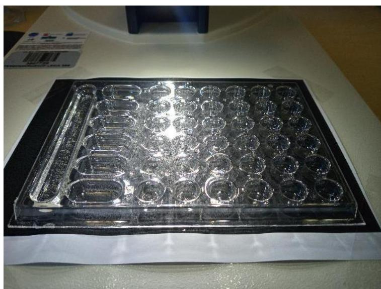
Slika 24: Rotoxkit F za izvedbo poskusov s kotačniki (Vir: [www.microbiotests.com](http://www.microbiotests.com)).
