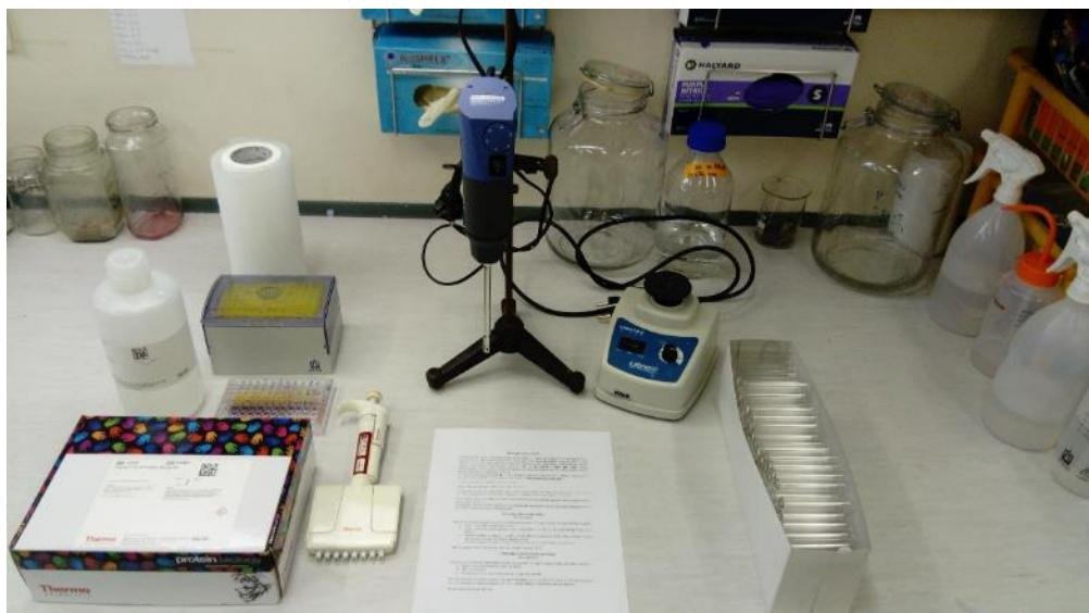
**Slika 29:** Laboratorijska oprema za homogenizacijo, tj. homogenizer IKA T10 Ultra Turrax) (Avtor.: Andraž Dolar).
