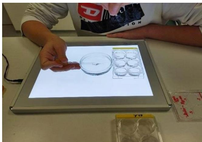
**Slika 28:** Svetlobna plošča za pomoč pri prenosu vodnih bolh (Avtor: Neža Novak).
