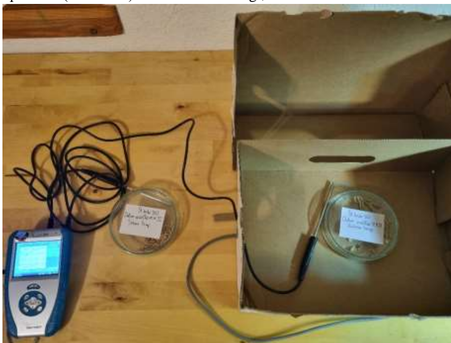
Slika 8: Petrijevka pri sobni temperaturi in petrijevka v škatli, pod katero sta grelni kabel in dlančnik, ki zapisuje podatke o temperaturi [Lasten vir]
