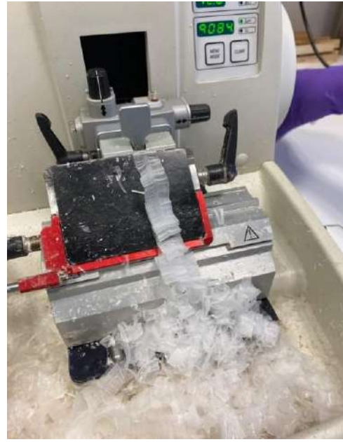
Slika 53: Postopek obrezovanja vzorca na rotacijskem mikrotomu (lastni vir)
