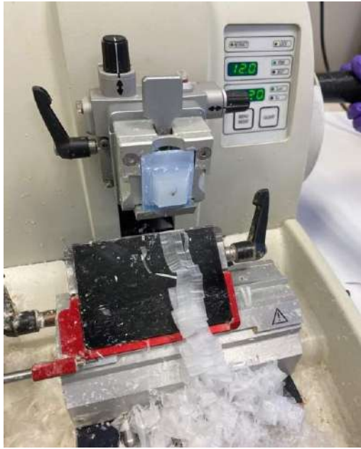
Slika 52: Postopek obrezovanja vzorca na rotacijskem mikrotomu (lastni vir)
