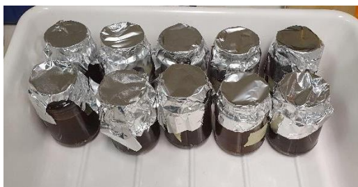
Sl. 2: Kozarčki z 10 g izvlečka in 90 mL 70% etanola pripravljeni za 24 urno stresanje. Avtor: Anej Cunk, 2022.
