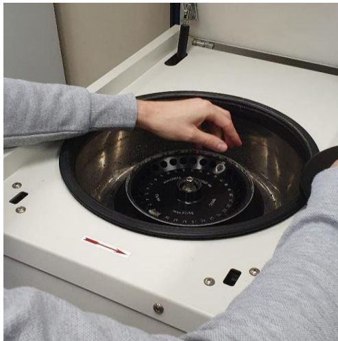
Sl. 4: Centrifugiranje vzorcev v ultracentrifugi. Avtor: Anej Cunk, 2023.
