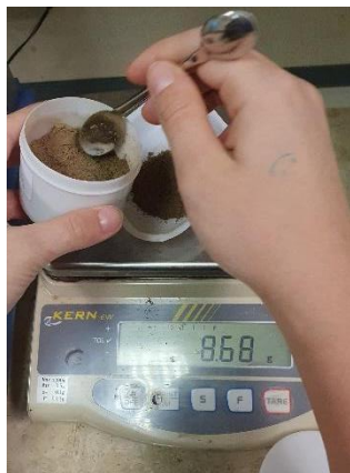
Sl. 1: Tehtanje finega prahu navadne ajde na točno 10 g z analitsko tehtnico. Avtor: Anej Cunk, 2022.
