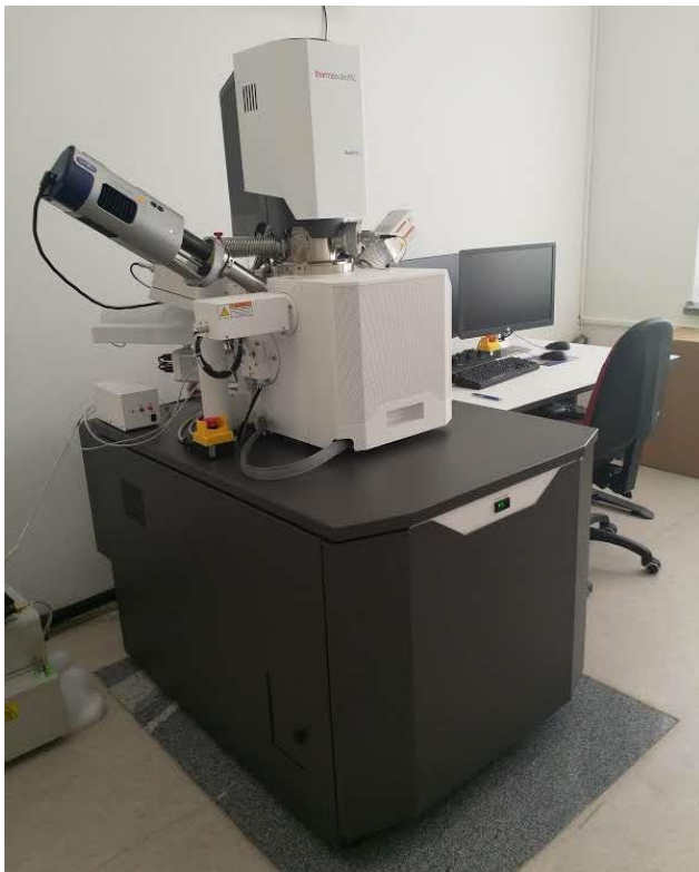
Slika 6: Vrstečni elektronski mikroskop Thermo Fisher Scientific, model Quattro S (UL NTF)
