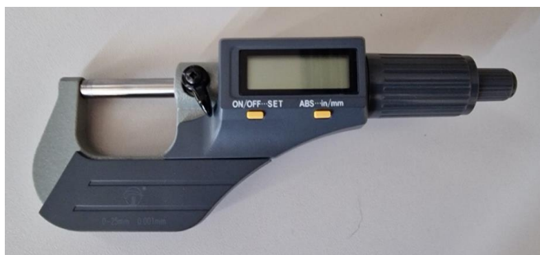
Slika 5. Mikrometer uporabljen za merjenje premera žic in lasu.
