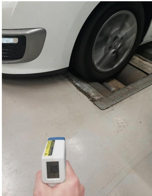
Slika 13: Temperatura ob koncu meritve - nov profil, nizek tlak
