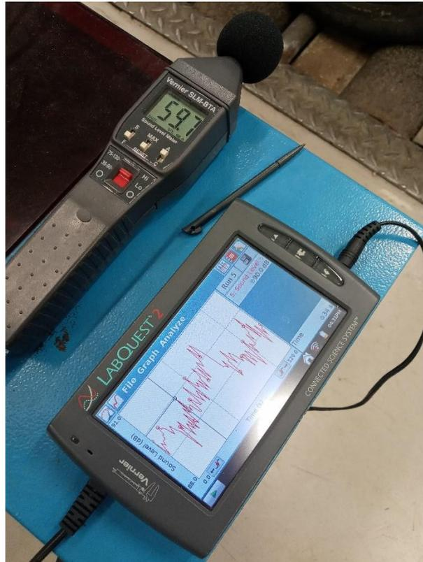
Slika 26: Decibel meter med meritvijo - obrabljen profil, visok tlak
