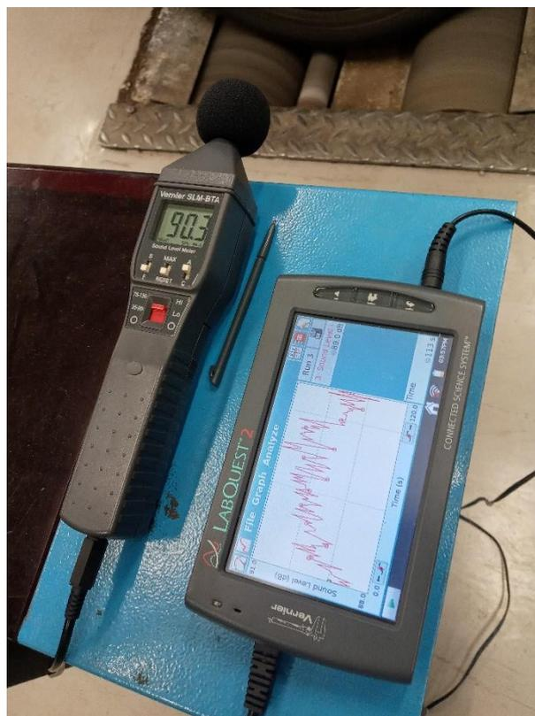
Slika 20: Decibel meter med meritvijo - obrabljen profil, optimalen tlak
