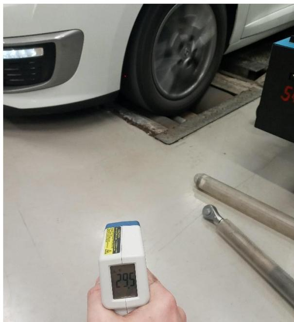
Slika 19: Temperatura ob koncu meritve - obrabljen profil, optimalen tlak
