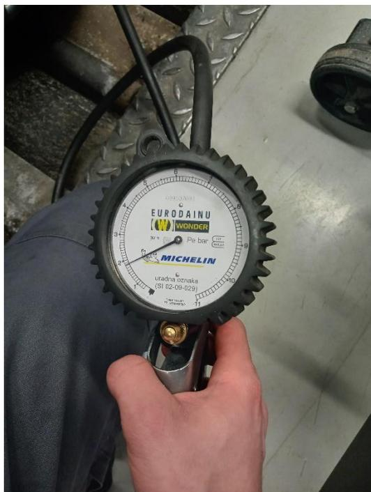
Slika 12: Manometer izmeri nižji tlak od idealnega - nov profil
