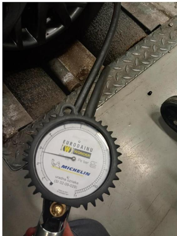
Slika 15: Manometer izmeri višji tlak od idealnega - nov profil
