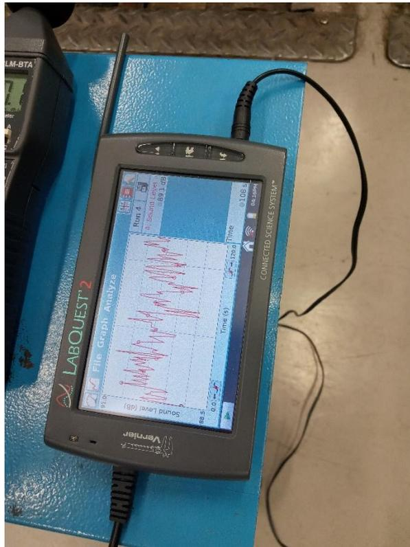
Slika 23: Decibel meter med meritvijo - obrabljen profil, nizek tlak
