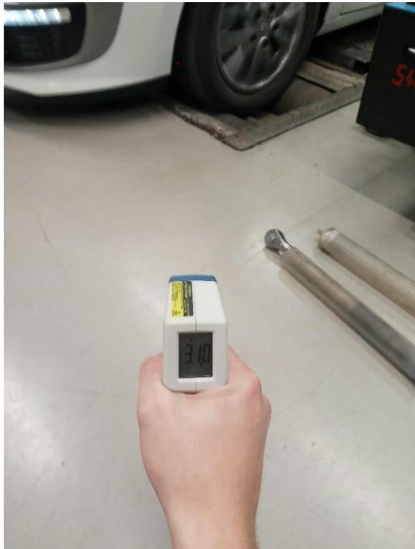
Slika 22: Temperatura ob koncu meritve - obrabljen profil, nizek tlak
