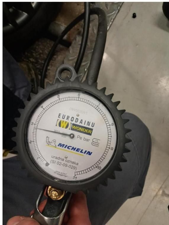
Slika 24: Manometer izmeri višji tlak - obrabljen profil
