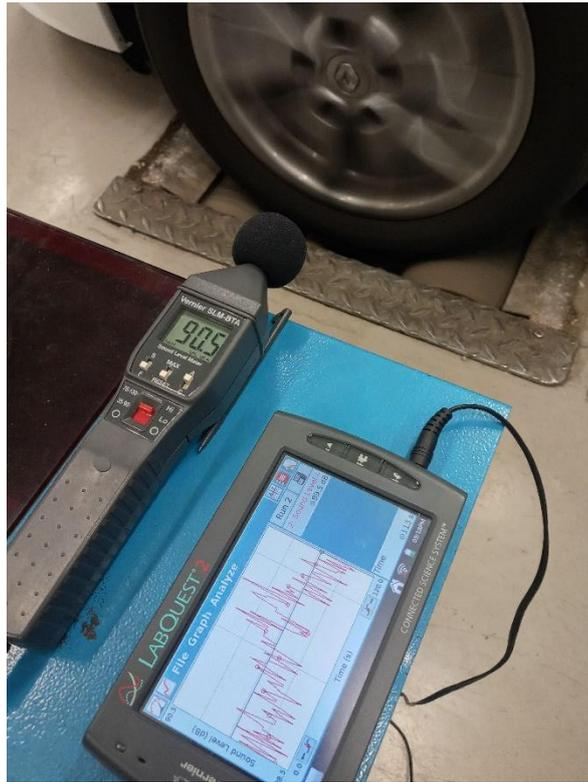
Slika 17: Decibel meter med meritvijo - nov profil, visok tlak
