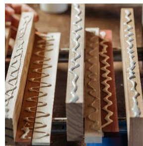
Slika 2: Nanašanje lepila na nosilce
