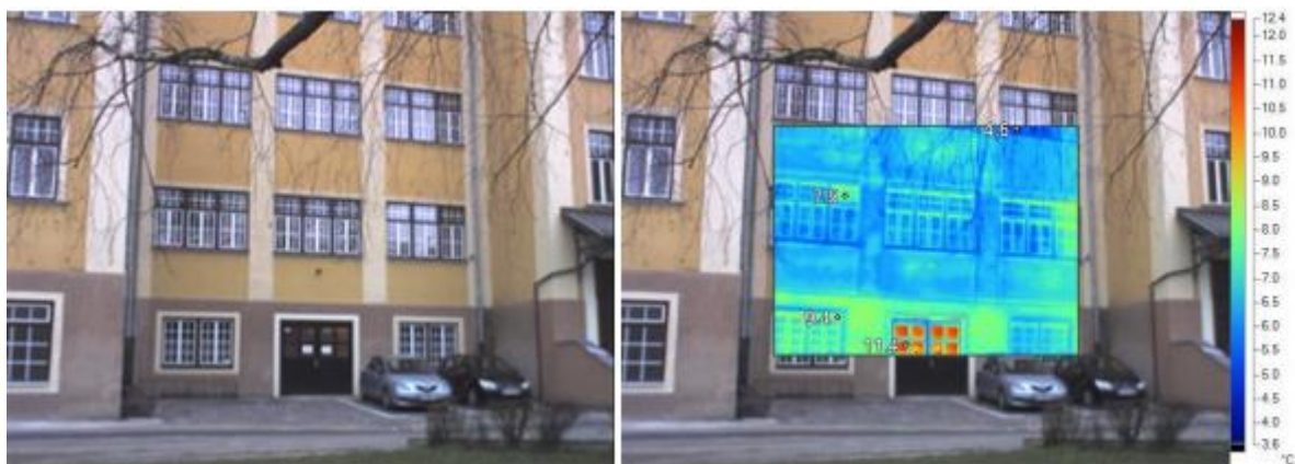
Slika 9: Izgube skozi okna na I. OŠ Celje
