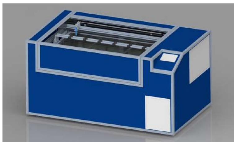
*Slika 11: 3D-model laserskega stroja*
