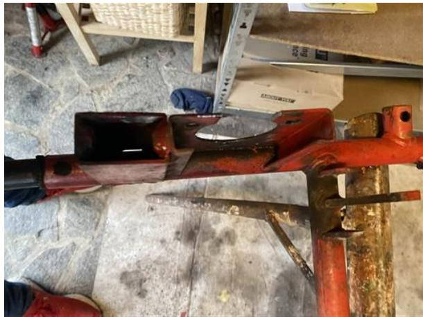
Slika 34: Odrezani nosilec držala za ležaj<sup>34</sup>
