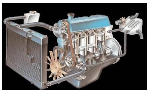
Slika 15: Tekočinsko hljeni agregat na viličarju<sup>15</sup>
