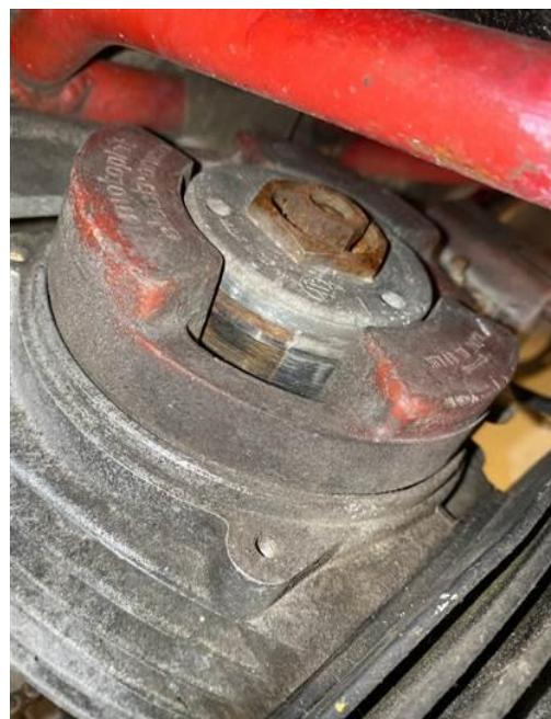
Slika 22: Elektromagneta na agregatu DAP T70<sup>22</sup>
