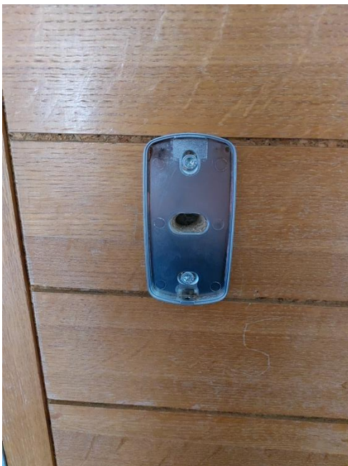
Slika 4: Okvir bralnika kartic, nameščen na steno. (Vir: lasten)
