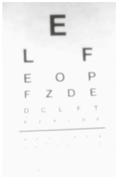
**Slika 35:** Fotografija, izdelana skozi luknjico 0,40 mm v aluminijasti foliji, osvetlitveni čas 1 min. 45 s.
