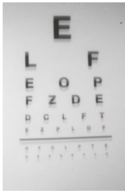
Slika 26: Fotografija, izdelana skozi luknjico 0,20 mm, osvetlitveni čas: 1 min. 30 s.
