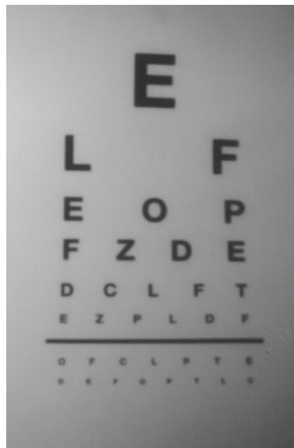
**Slika 29:** Fotografija, izdelana skozi luknjico 0,30 mm, osvetlitveni čas 2 min.
