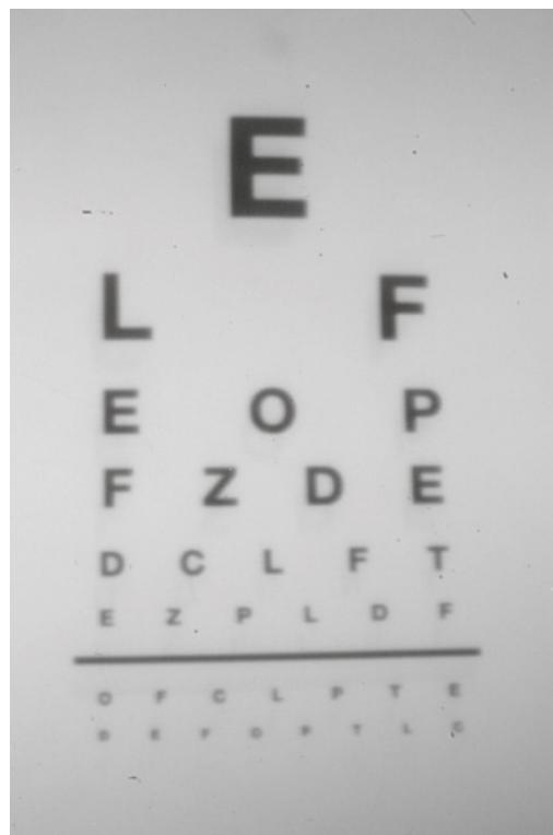
**Slika 30:** Fotografija, izdelana skozi luknjico 0,40 mm, osvetlitveni čas 1 min. 45 s.
