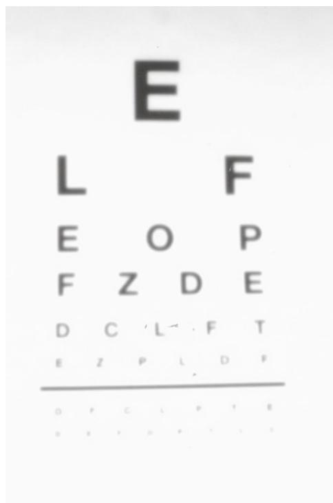
Slika 33: Fotografija, izdelana skozi luknjico 0,60 mm, osvetlitveni čas 1 min. 20 s.
