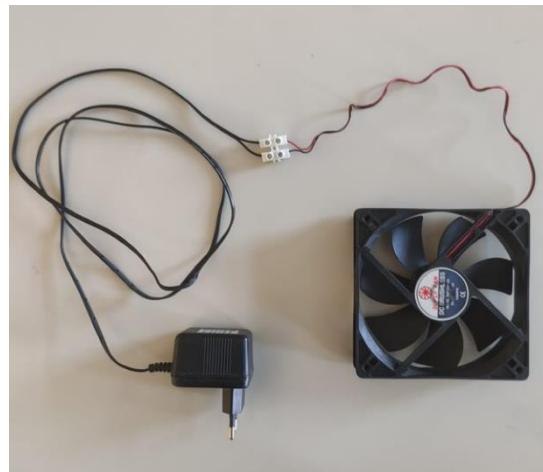
**Slika 12: Ventilator z napajalnikom.**
