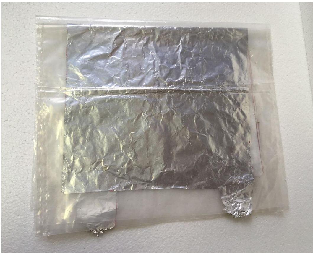
Slika 11: Izdelani izhodni kondenzator iz plastičnih vreč in aluminijaste folije, enkrat prepognjen
