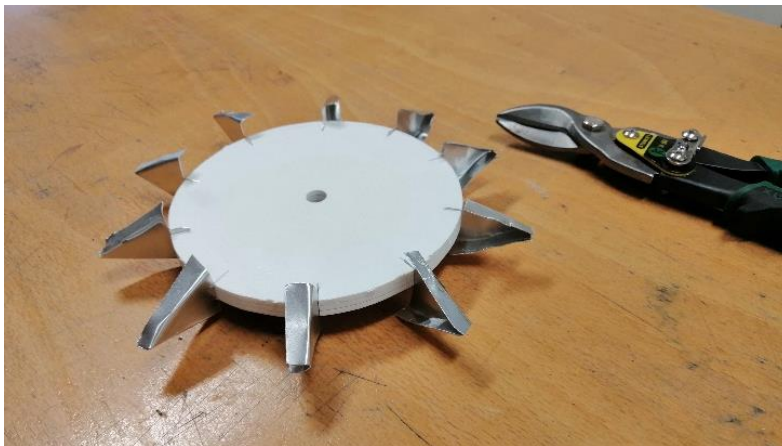
Slika 9: Rotor in 10 trikotnih lopatic z zavihki (vir: lasten)
