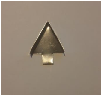
Slika 3: Trikotna lopatica z zavihki
