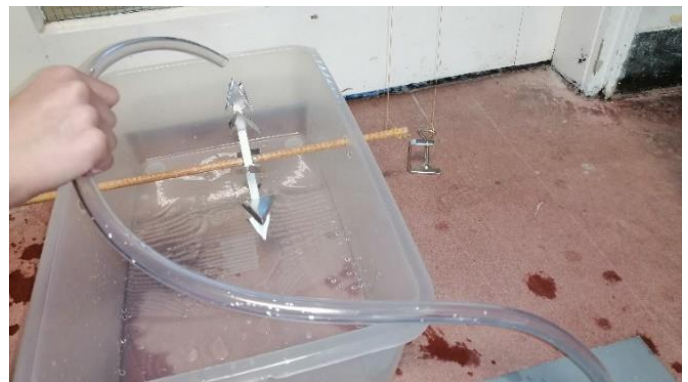
Slika 13: Preizkušanje trikotnih lopatic z zavihki
