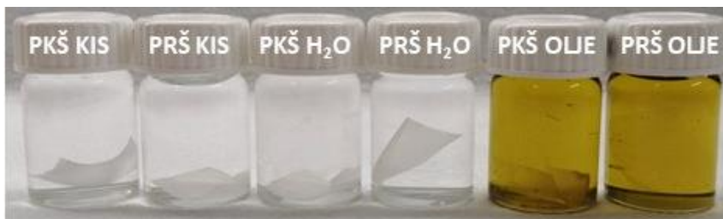
Slika 34: Razgradnja vzorcev PKŠ1 in PRŠ v kisu, vodi in olivnem olju 60. dan.
