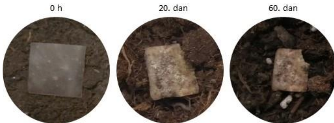
Slika 35: Razgradnja PKŠ vzorcev v suhi zemlji v sobi.
