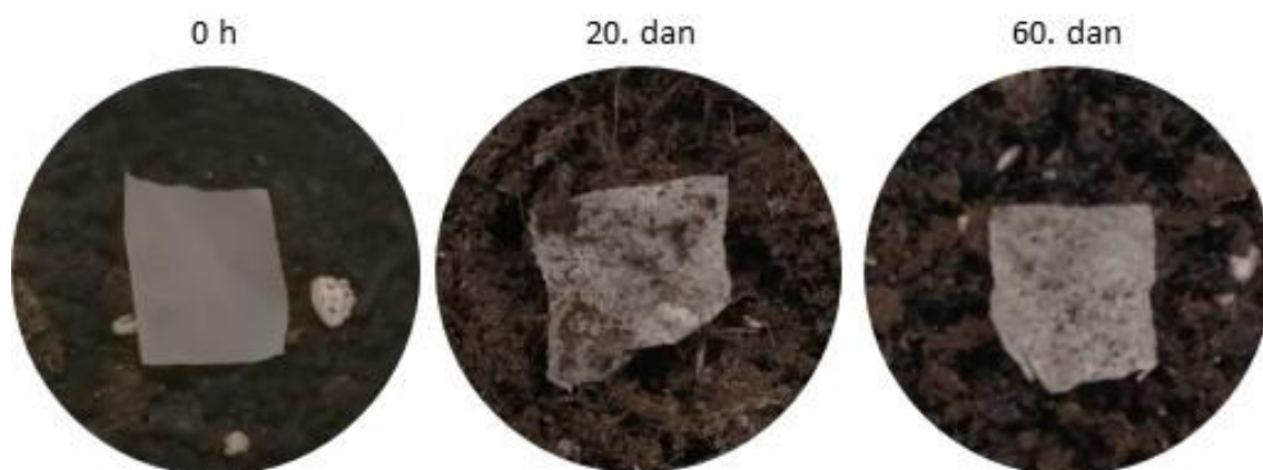
Slika 41: Razgradnja PRŠ vzorcev v zalivani zemlji v sobi.
