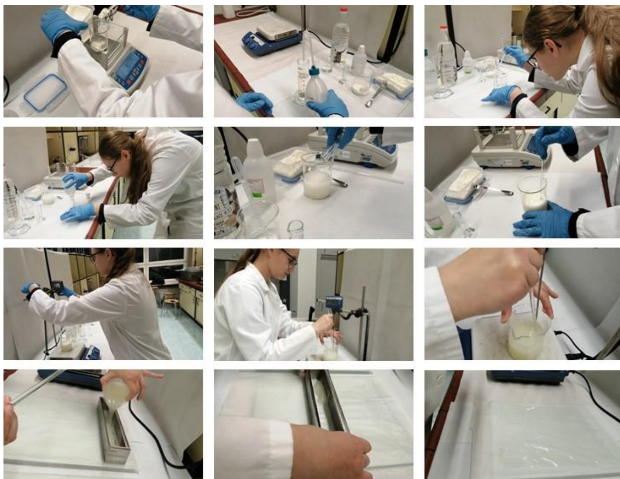
Slika 20: Postopek sinteze bioplastike iz krompirjevega škroba.
