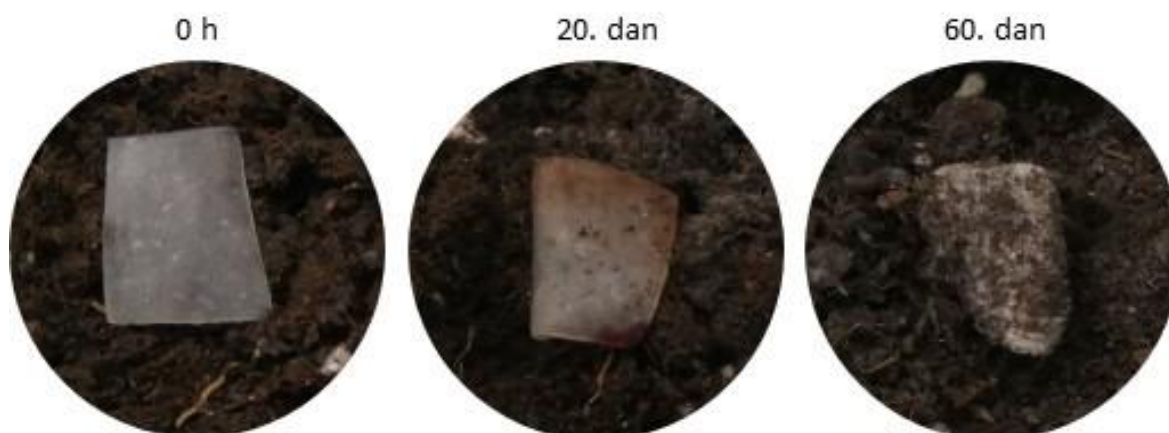
Slika 36: Razgradnja PKŠ vzorcev v suhi zemlji na balkonu.
