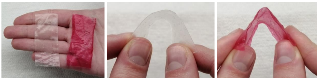
Slika 21: Vzorci bioplastike iz krompirjevega škroba brez (PKŠ) in z barvilom (PKŠB).
