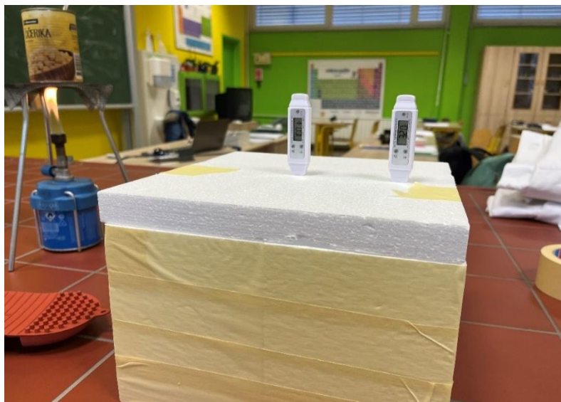
Slika 9: Merjenje temperature zraka in mivke v škatli
