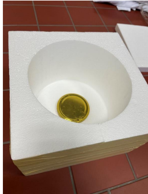
Slika 8: Izolacijska škatla iz stiropora
