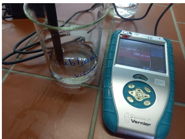
Slika 7.1: Merjenje električne prevodnosti (Avtor: Emilija Šebök)
