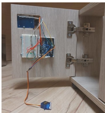
Slika 4.14: Namestitev RFID ključavnice na omarico.
