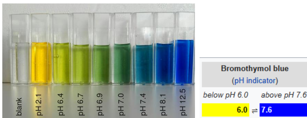
Slika 11. Barvna lestvica za indikator bromtimol modro v odvisnosti od pH (Sigma Aldrich, 2022) 8
