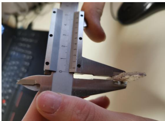
Slika 28. Merjenje debeline vzorca s kljunastim merilom.
