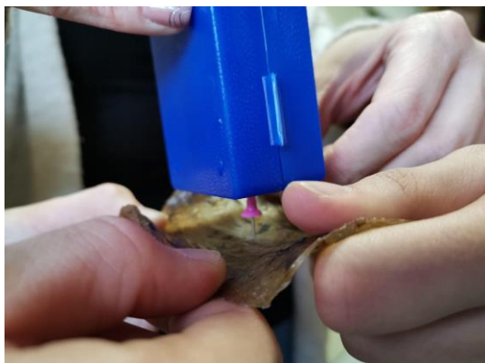
Slika 27. Določanje trdote bioplastike.
