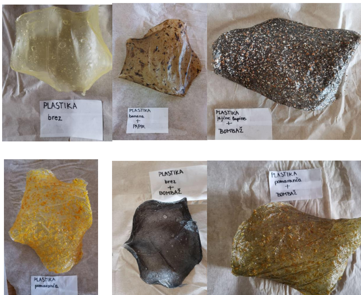
Slika 25. Bioplastika 1. dan sušenja.
