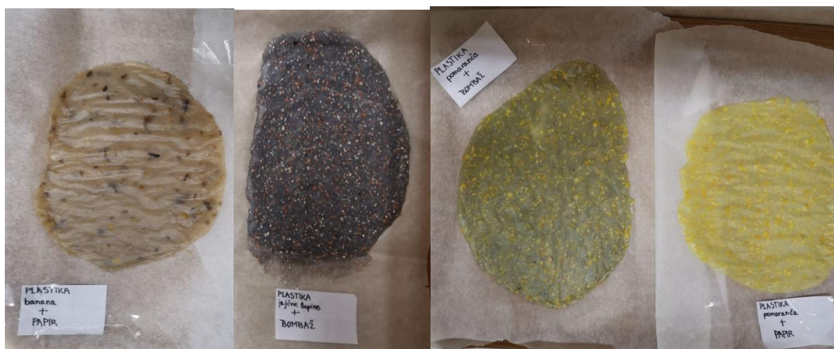
Slika 25. Bioplastika 1. dan sušenja.
