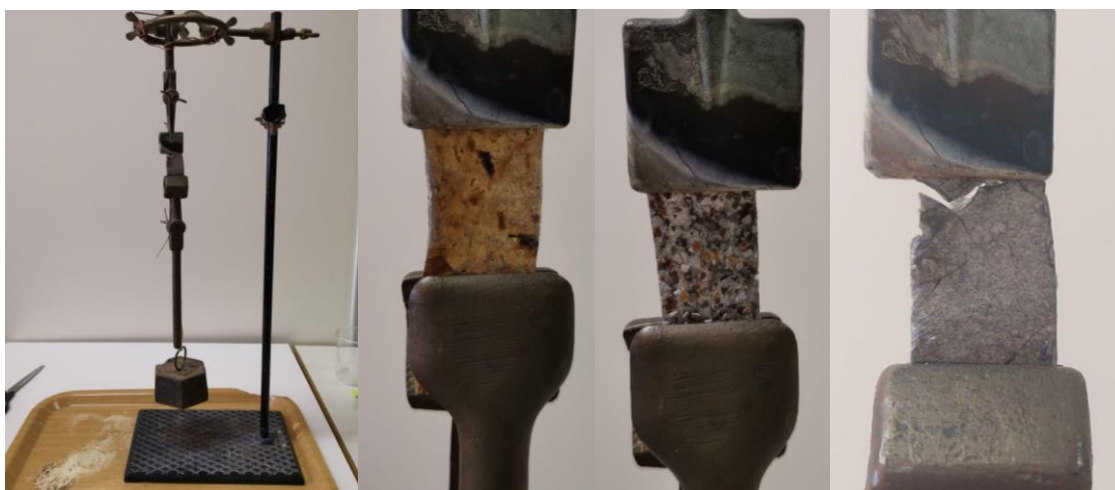
Slika 31. Merjenje raztezka vzorcev bioplastike s pomočjo uteži.
