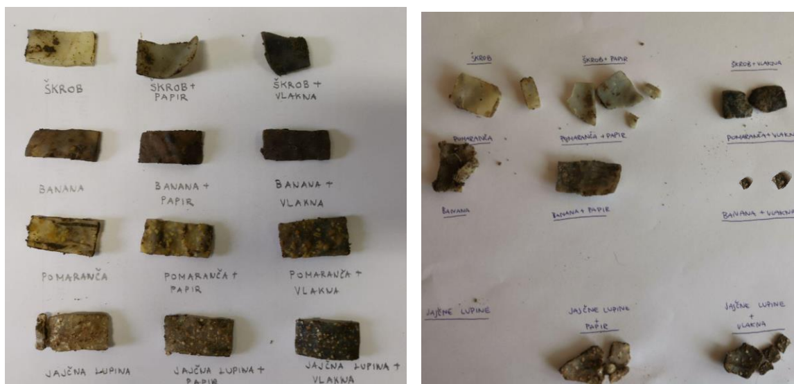
Slika 30. Vzorci bioplastike po treh in petnajstih dneh v prsti.
