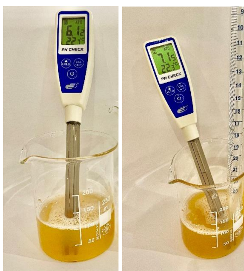
Slika 22: pH ekstrakta iz krompirja pred dodano sodo bikarbono (levo) in po dodani sodi bikarboni (desno) (Foto: J. A. Sever).
