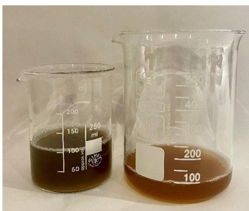
Slika 23: Ekstrakt PPO hitreje počrni ob dodatku sode bikarbone (levo) (Foto: J. A. Sever).
