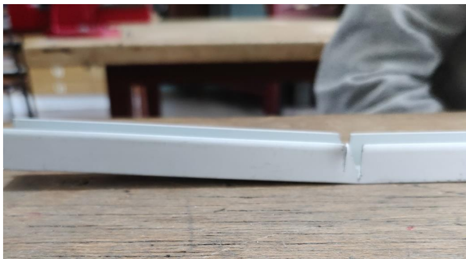
Slika 15: Izrez na U profilu aluminija
