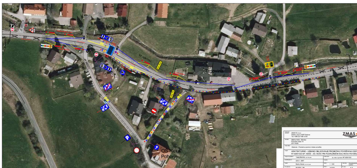
Slika 21: Načrt uvedbe dodatnih sodobnih varnostnih ukrepov v bližini PŠ Reka-Pohorje. Pridobljeno z osebno komunikacijo, od S. Rafolt, 16. februar 2023, Spodnje Hoče: Občina Hoče-Slivnica. Avtorske pravice [2021] od M. Abram. Pridobljeno/uporabljeno z dovoljenjem.
