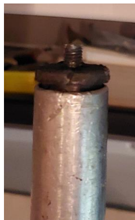
Slika 20: Rešitev, kako so palice pritrjene na stene kombija
