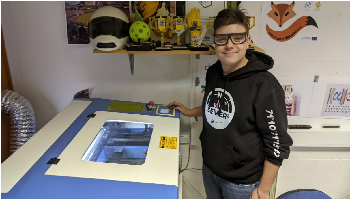
Slika 18: V laserski stroj vstavimo vezano ploščo in umerimo lasersko glavo, da je od materiala oddaljena točno 9 mm. Nastavimo izhodiščno točko in pritisnemo Start. (Fotografija: Lina Ledinek)
