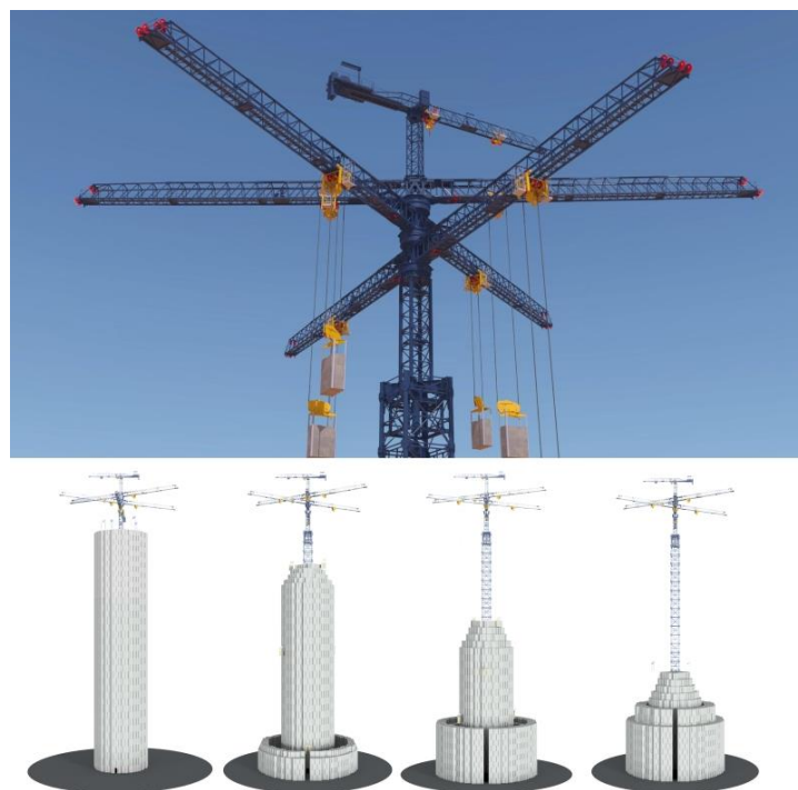
Slika 3: Zlaganje betonskih blokov na kup.
