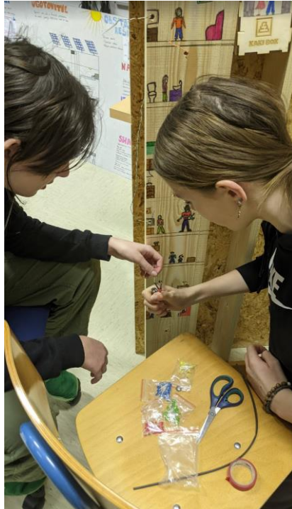
Slika 11: Najprej smo diode prispajkali neposredno na žice, a so pogosto pregorele. Nato smo se domislili izvirnega načina, ki omogoča menjavo. (Fotografija: Alex Glazer)
