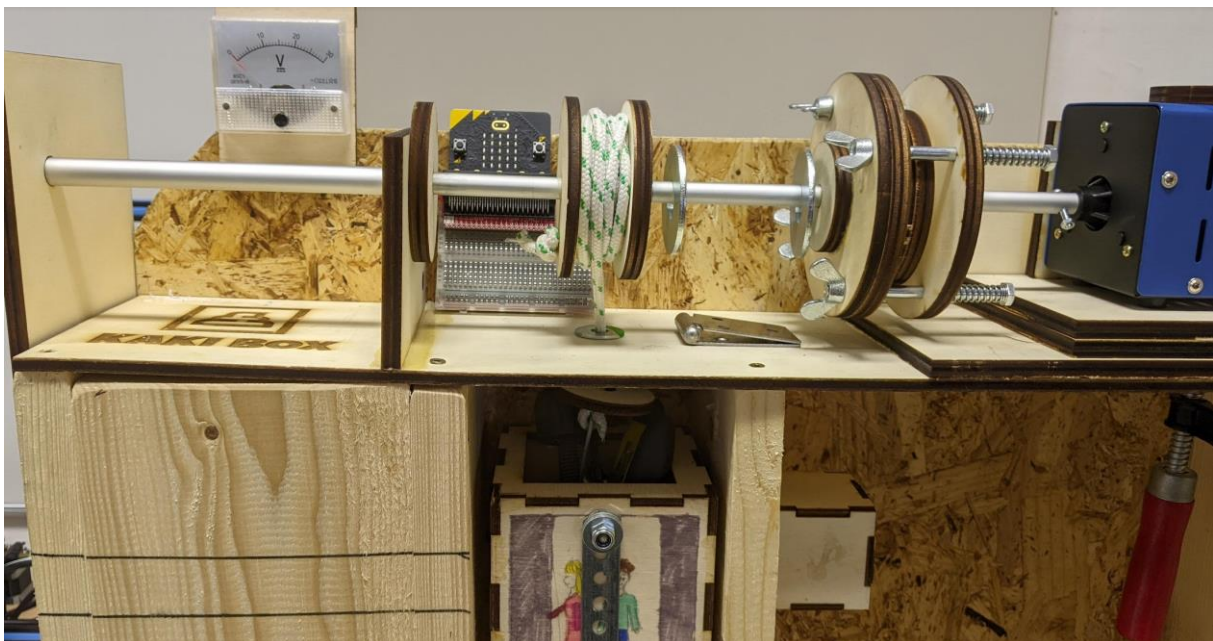
Slika 10: Naš model smo nadgradili z močnejšim generatorjem in sklopko. (Fotografija: Lina Ledinek)
