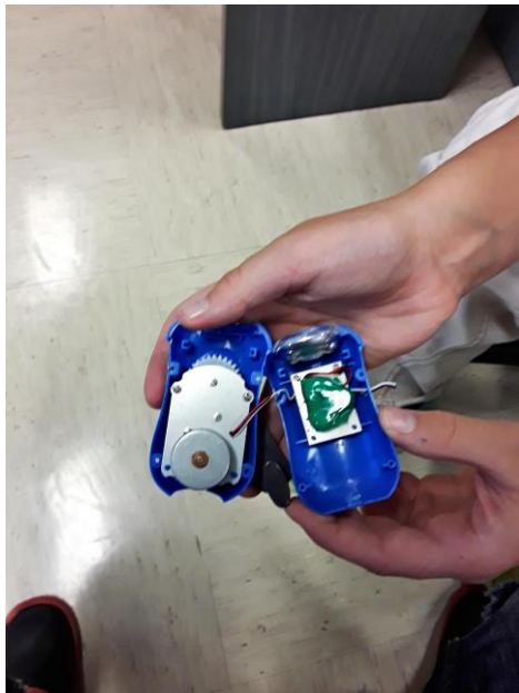
Slika 12: Razstavili smo žepno svetilko z generatorjem, kjer so vidni zobniški prenosi. (Fotografija: Alex Glazer)
