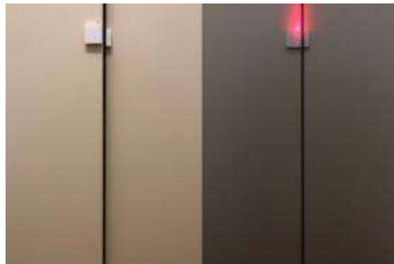
Slika 19: Preizkus delovanja izdelka pri odprtih (levo) in zaprtih (desno) vratih (lasten vir).
