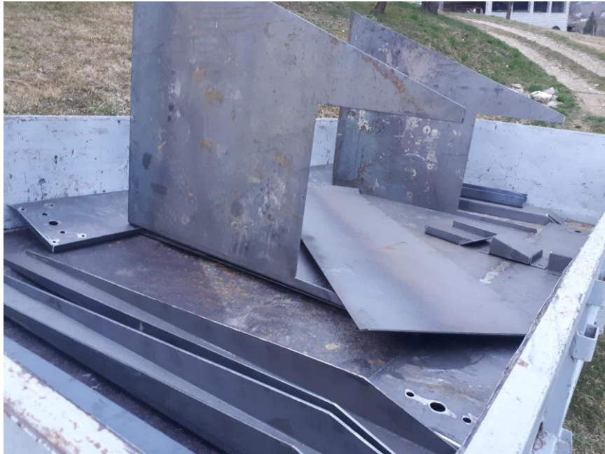
Slika 18: Priprava pločevine na sestavljanje (osebni arhiv)
