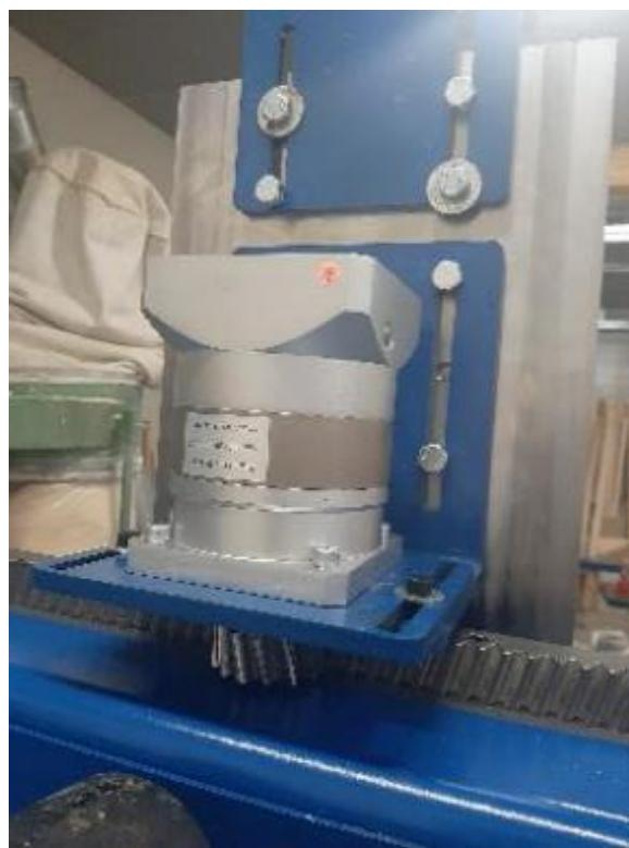
Slika 46: Montaža reduktorja na x osi
