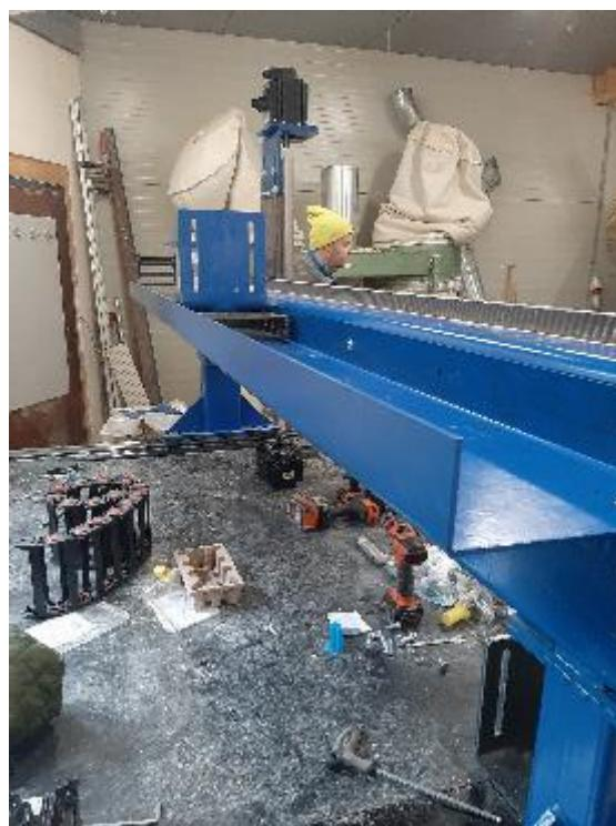
Slika 48: Montaža kanala za energetsko verigo na x osi
