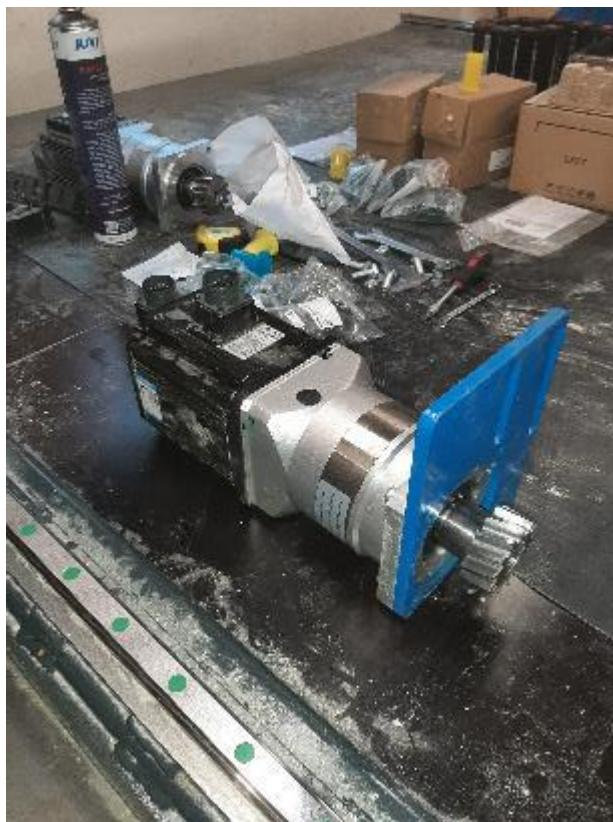
Slika 44: Sestava servomotorja, reduktorja, nosilca in zobnika
