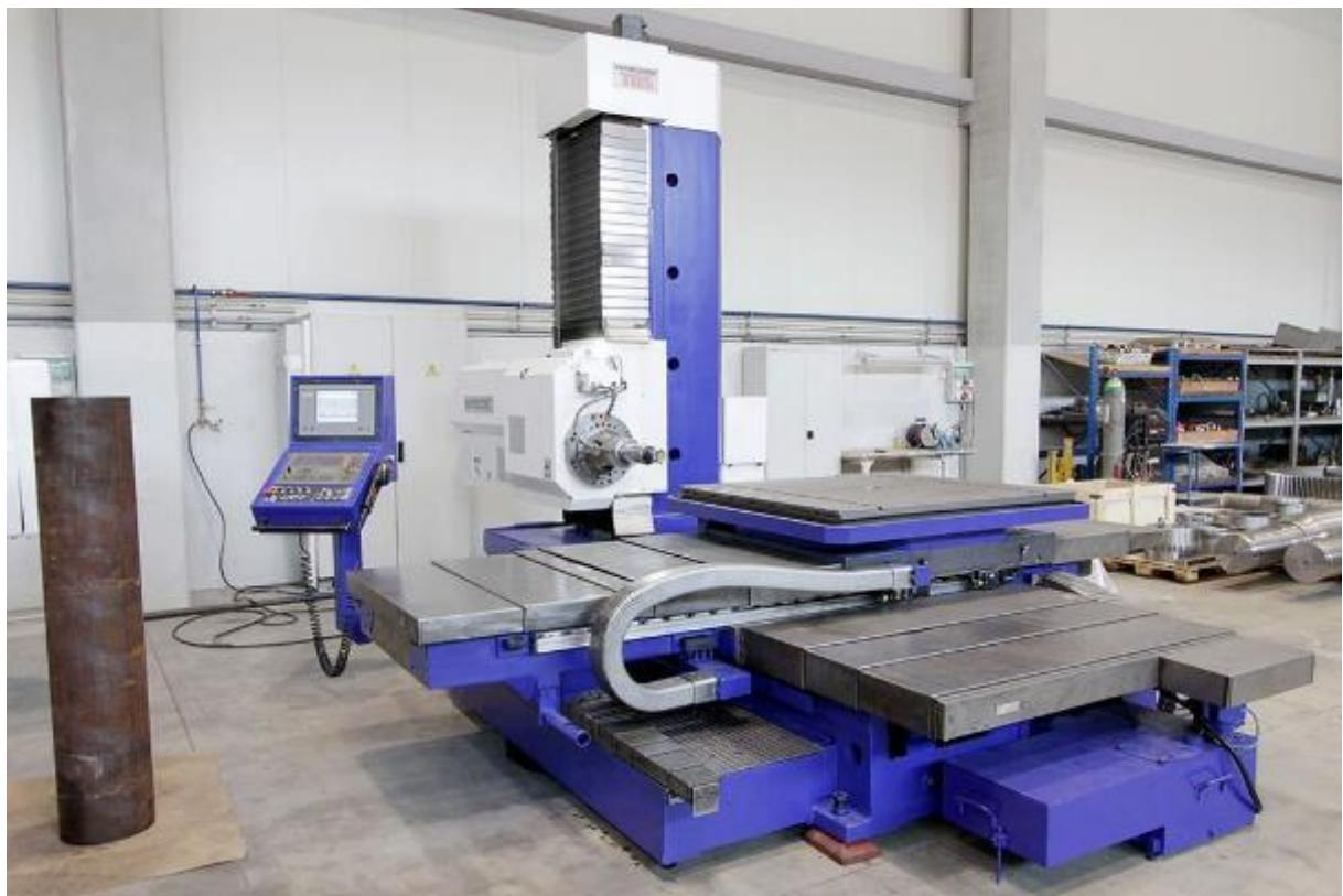
Slika 34: Rezkalni stroj Bohrwerk
