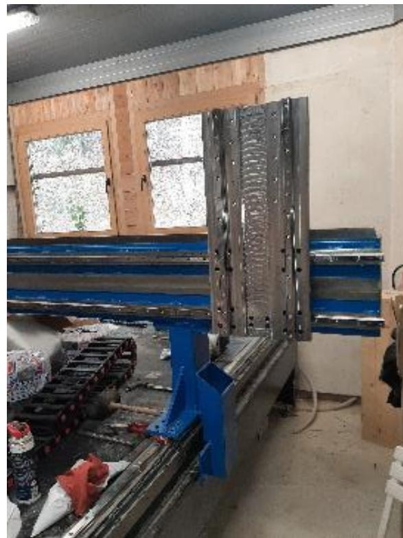
Slika 42: Montaža z osi na most
