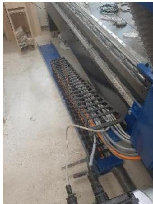
Slika 49: Montaža kanala in verige na y osi
