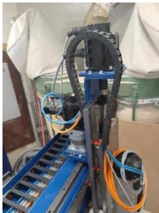
Slika 50: Montaža energetske verige na z osi
