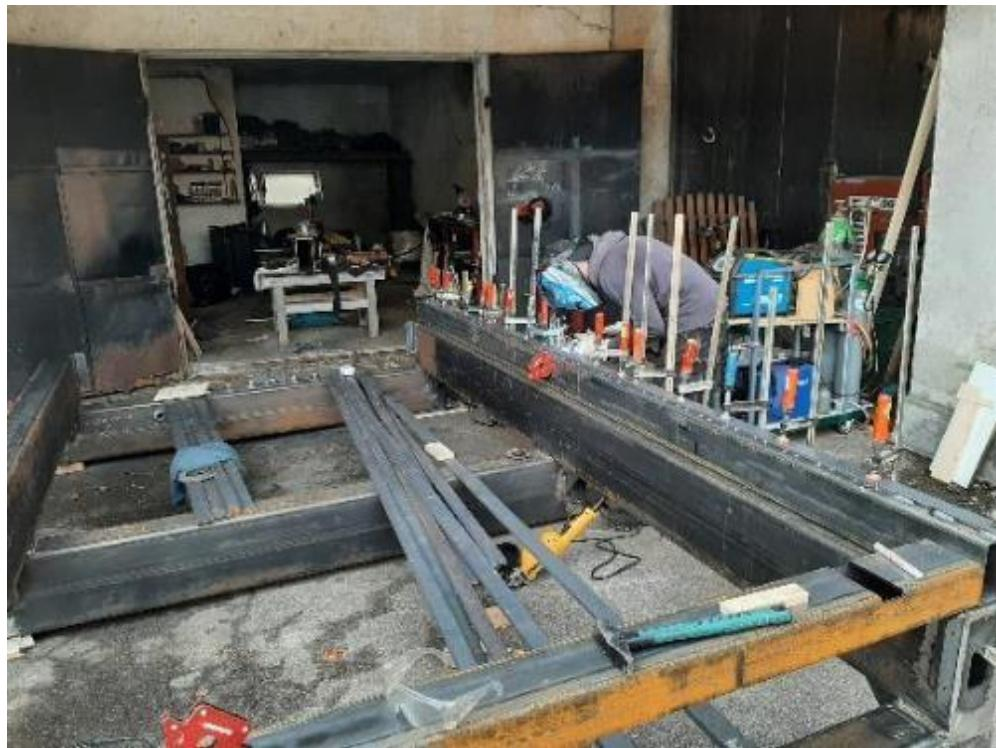
Slika 21: Varjenje jeklenih valjancev
