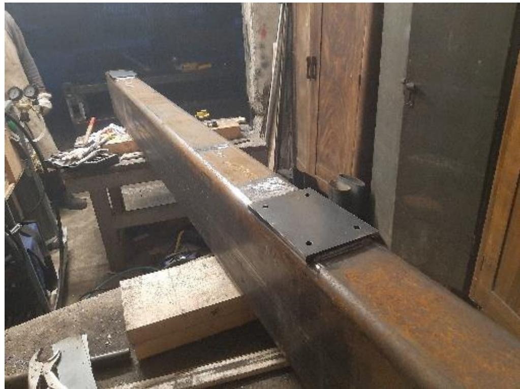
Slika 26: Varjenje plošč za pritrditev stebrov
