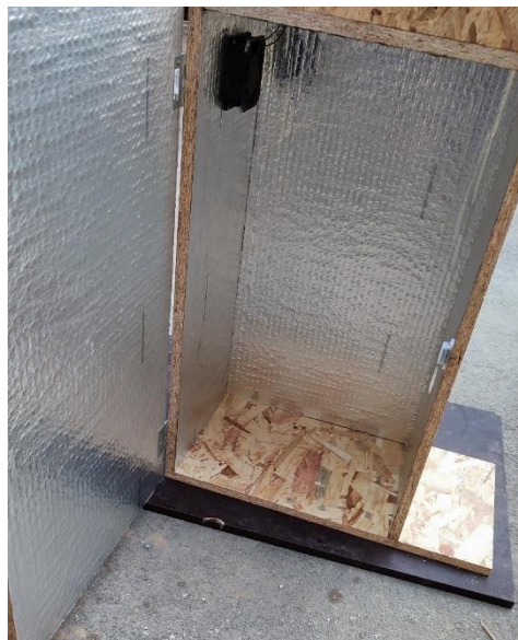
Slika 7: Sestavljeno ohišje s folijo in ventilatorjem
